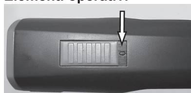
Fig. 4 Interruttore in posizione ferma ("0")
